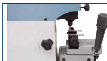
3 Blokada wałka przesuwania pionowego
