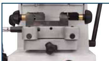
2 Bloqueio do eixo de deslocamento lateral.
