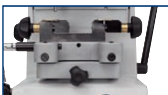
2 Bloqueo eje desplazamiento lateral.
