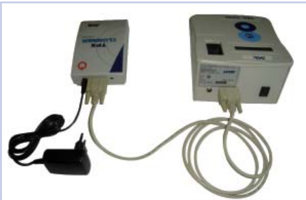
Imagem 3. Seguir os três passos para ligar o TPX CLONER ao TRS5000.
