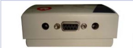
Figura 2. Parte posteriore del TPX CLONER con i connettori CC e la connessione della porta seriale.
