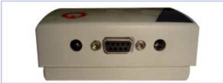
Imagem 2. Parte posterior do TPX CLONER com os conectores CC e a ligação da porta de série.
