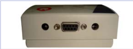
Abbildung 2. Rückseite des TPX CLONER mit den zwei DC-Buchsen und dem Serienport-Anschluss.
