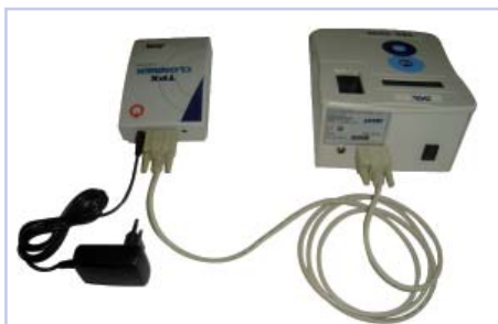
Imagen 3. Segundo de los tres pasos para conectar el TPX CLONER y la TRS5000.
