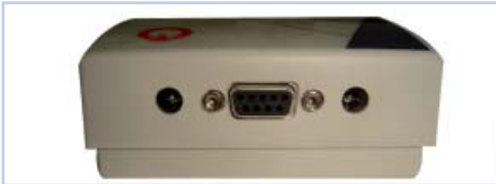
Image 2. Dos du TPX CLONER avec les connecteurs DC et la connexion de port série.
