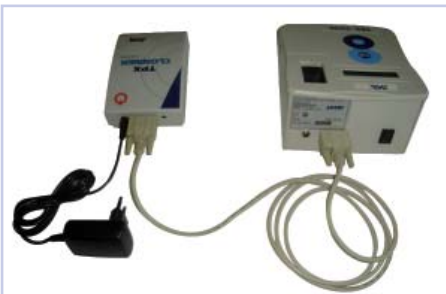
Image 3. Deuxième des trois étapes de raccordement du TPX CLONER à la TRS5000.
