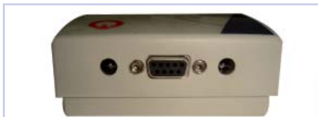
Imagen 2. Parte posterior del TPX CLONER con los conectores DC y la conexión de puerto serie.
