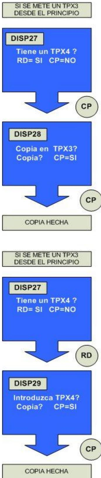
EL TPH CLONER detecta automáticamente la incompatibilidad del TPX3 con el modelo que se está tratando de clonar. Aparecerá el mensaje del Display 27, que nos indica la necesidad de un TPX4.
